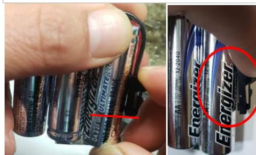
8.- Desdoblar el arnés y colocar la pieza en el contenedor de piezas terminadas. No colocar piezas encima de otras y mantenerlas de pie.
